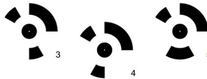
Diese Zielmarken werden vollautomatisch mit einer hohen Subpixelgenauigkeit von **ELCOVISION 10** gemessen und damit kann man, bei Verwendung von hochwertigen Kameras, auch an großen Objekten wie z.B. Brücken hohe Genauigkeiten im 0.02mm Bereich erreichen. Damit lassen sich dann z.B. sehr genaue Deformationsvermessungen durchführen.
