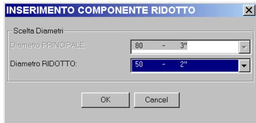
Dopo l'inserimento di una riduzione le linee immediatamente a monte e a valle di essa, e solo quelle, assumono i DN impostati.
