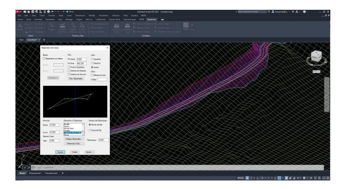
También incluye numerosas herramientas de replanteo de viales, con posibilidad de calcular y analizar elementos de la sección, generar listados de vértices de plataforma, cunetas, taludes, vértices de cajeo, capas de firme, cotas, etc. Otros comandos útiles permiten realizar el análisis, control e informe de un levantamiento sobre un modelo digital del terreno modificado y/o sobre perfiles elaborados de diseño.
